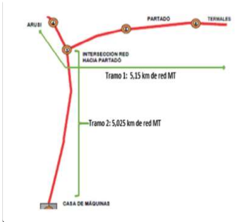
Grafica 3. Redes de media tensión construidas Arusí, Partadó, Terales y Casa de máquinas.
