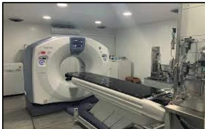
Figura 20. Tomografía axial computarizada. Laboratorio de la UIS. (Tomado del Grupo de Investigación en Tomografía computarizada para caracterización de yacimientos.)
