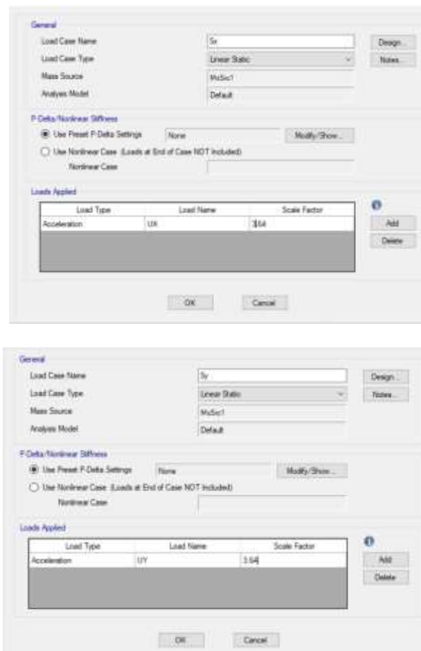
Figura 19 Aceleración sísmica horizontal del elemento no estructural
