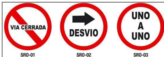
Señales Reglamentarias en Obra
