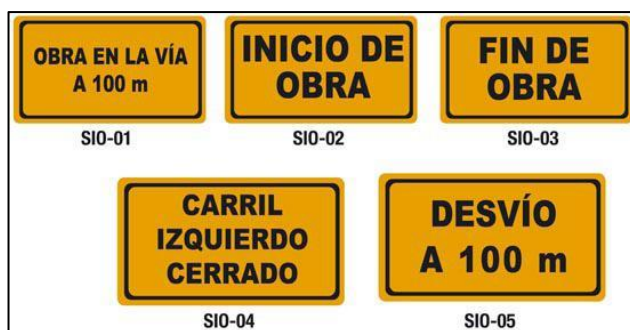
Señales Informativas en Obra
