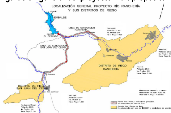
Figura. Configuración general del proyecto multipropósito río Ranchería
