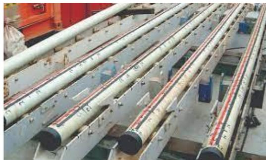
Figura 73. Racks de manejo y preservación de núcleos en el pozo.
