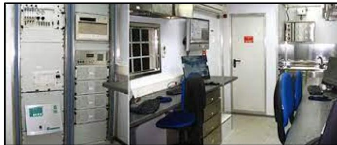
Figura 72. Caseta de mud logging con seguimiento a pozos y parámetros de perforación.
