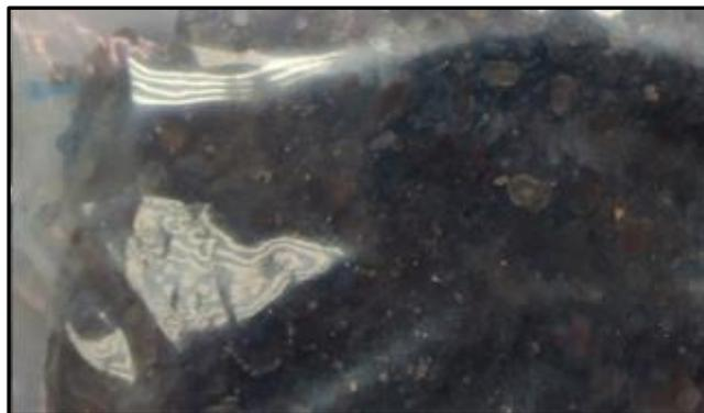
**Figura 54. Areniscas y calizas en el tope de 6600-6620 ft. Granulación de 2 mm de diámetro. Intervalo de la discordancia. Tomado de muestras lavadas de rípios de zanja húmeda recuperados del pozo Tierralta 2XP.**
