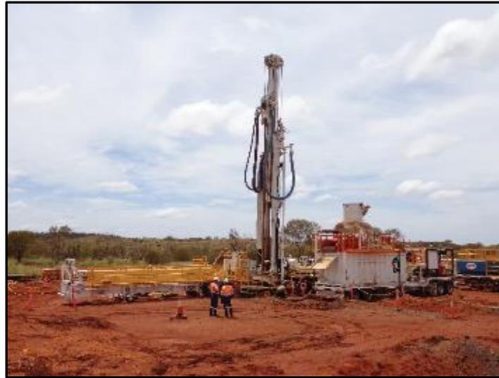
Figura 71. Foto de un equipo multipropósito en una locación con equipo de control de sólidos.
