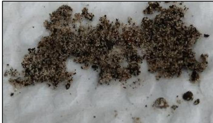
Figura 62. Intervalo de 8210-8220. Cuerpo de arenisca, pero texturalmente. Contiene muchos clastos de caliza y lodolita calcárea, junto con otros clastos no identificados. Diámetro del grano de 0.25 mm-0.55 mm con clastos de diferente origen. La imagen es de 5\*3 cms.
