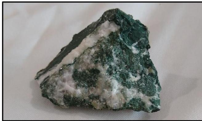
**Figura 22. Roca ígnea tomada en la cantera cercana a Montería. La roca presenta muchas diaclasas rellenas con posible carbonato de disolución.**
