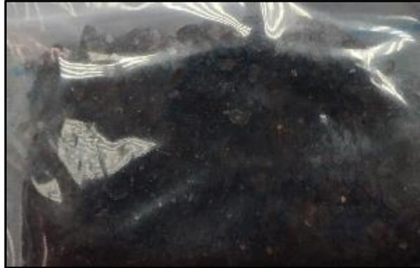
**Figura 5. Los gránulos de esta muestra no superan los 2-3 mm de diámetro. Efecto grinding en las muestras de ripios recuperados. Material muy molido por bajo peso del taladro y pobre capacidad de arrastre.**
