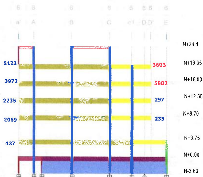
Vigas voladizos edificio B, eje 6
