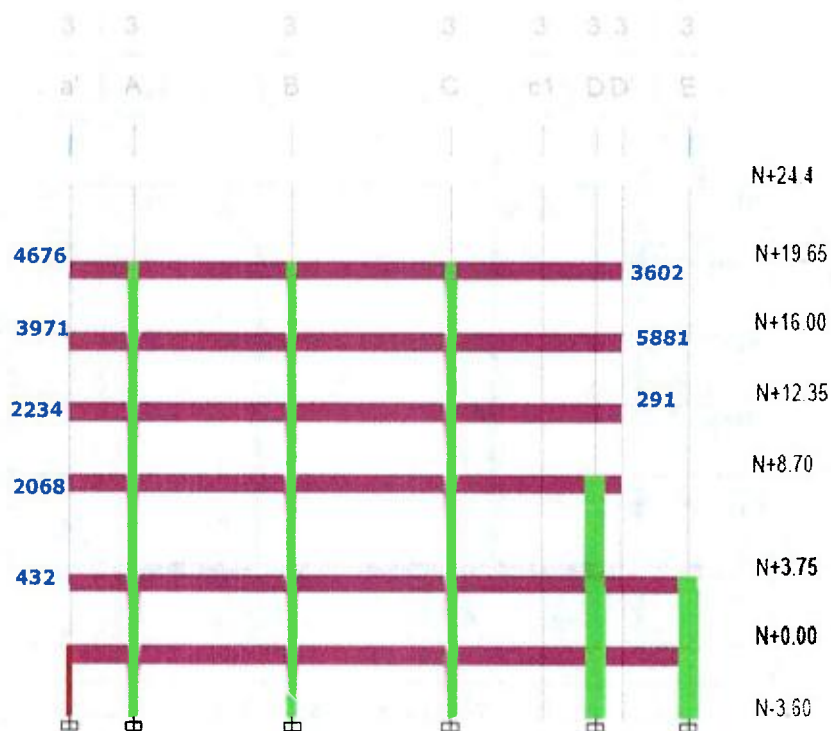
Vigas voladizo edificio B, eje 3
