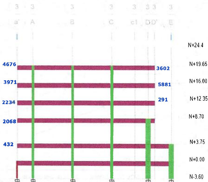
Figura 27 Vigas voladizo edificio B, eje 3
