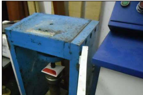
Gráfico 13. Ensayo de resistencia a la compresión a tachas reflectivas
