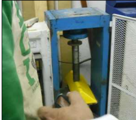
Gráfico 18. Ensayo de compresión a bordillo traspasable.
