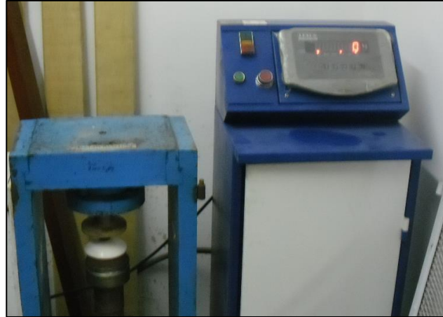
Gráfico 10. Ensayo de resistencia a la compresión de estoperoles
