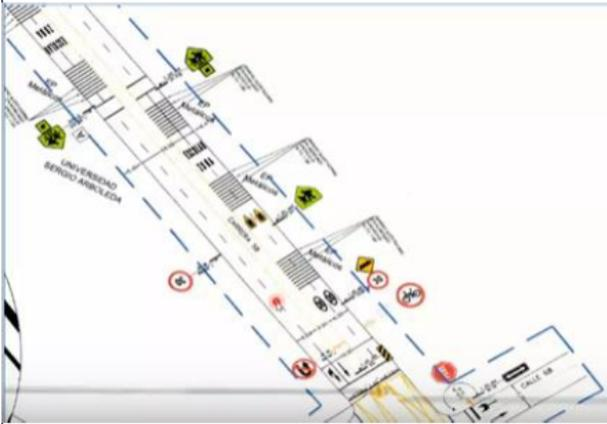
Con este ejemplo se resalta que la velocidad debería ser previamente reducida modificando el diseño de señalización de la vía y sólo después se puede instalar la señal Zona Escolar y sus regulaciones de pasos peatonales. Debe complementarse con marcas y mensajes sobre el pavimento.
