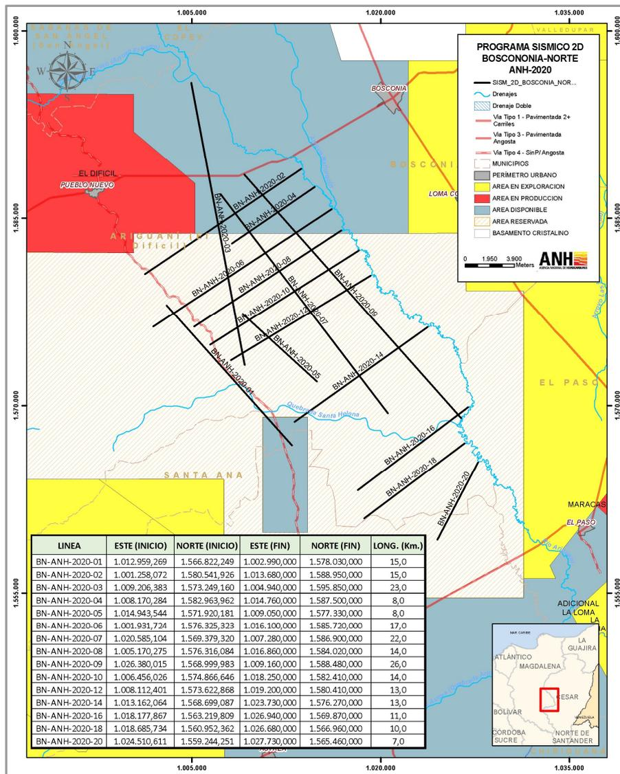
**Figura 1. Localización y coordenadas del programa sísmico Bosconia Norte 2D**
